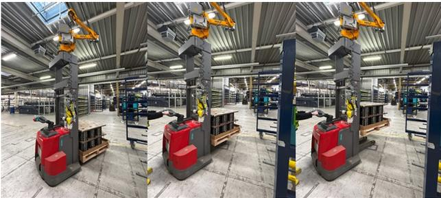
Elektrogabelhubwagen mit Sonderaufbau zur ergonomischen Entnahme der einzelnen Carbonspulen
