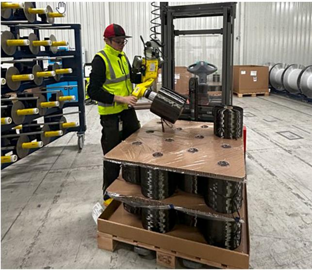
Handlingshilfe in horizontale Richtung drehen, damit die Carbonspule aufbestückt werden kann.
