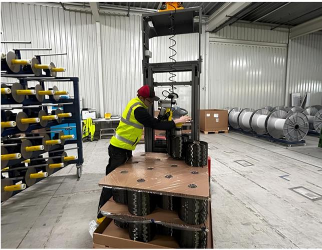
Carbonspule mit der Handlingshilfe vertikal aufnehmen.
