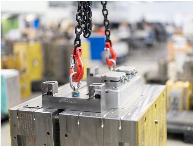
Bild 1: Spritzgusswerkzeug mit Werkzeugbrücke am Kran
