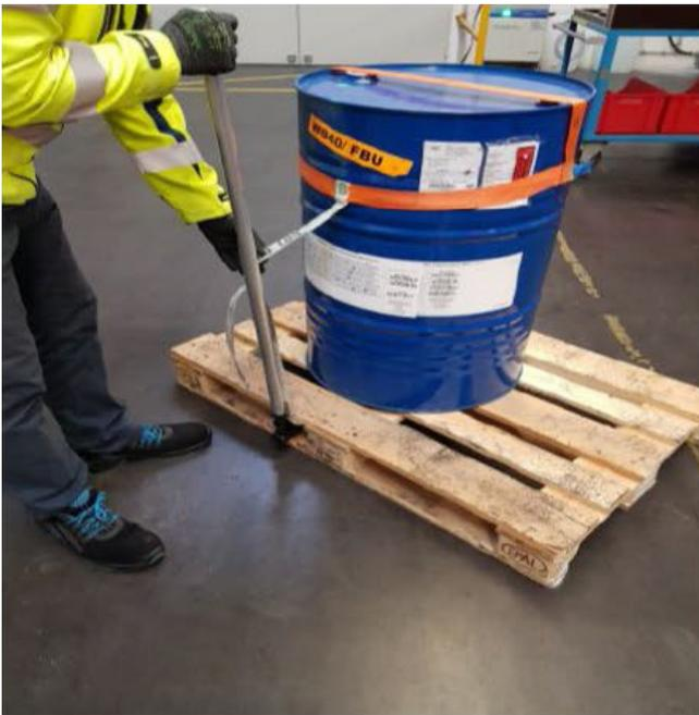
Der Magnet kann mit Hilfe des Hebels abgestreift werden. Jetzt kann man die Bänder der Einzelfasssicherung straff ziehen um einen Verbund von Fass und Palette herzustellen.
