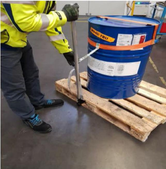
Der Haken wird mit Hilfe der Einfädelhilfe unter die Palette geführt und in der Palette eingehakt
