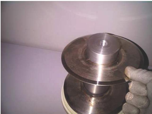
Distanzringe zwischen den Messern erleichtern die Entnahme
