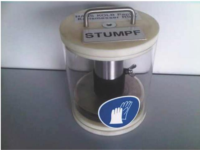
Entnahme bzw. Einsetzen von Messer
