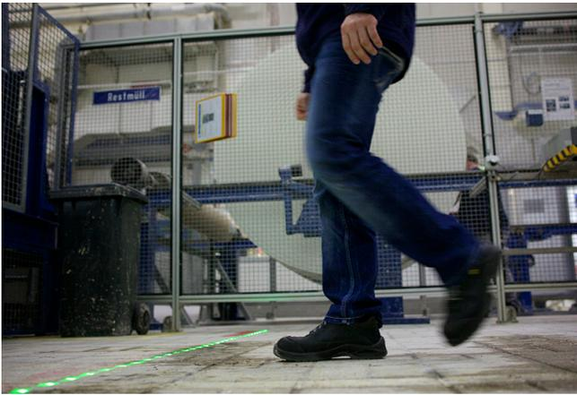
Verblüffend einfach: Die in den Boden eingelassenen LED-Leisten signalisieren deutlich, ob man gehen kann...
