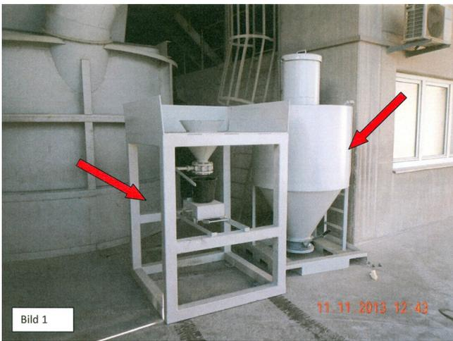
Die von uns konstruierte mobile Probenahmeausrüstung besteht aus einem Gestell mit Trichter (links im Bild 1) sowie einem kleinen siloförmigen Behälter (rechts im Bild 1).
