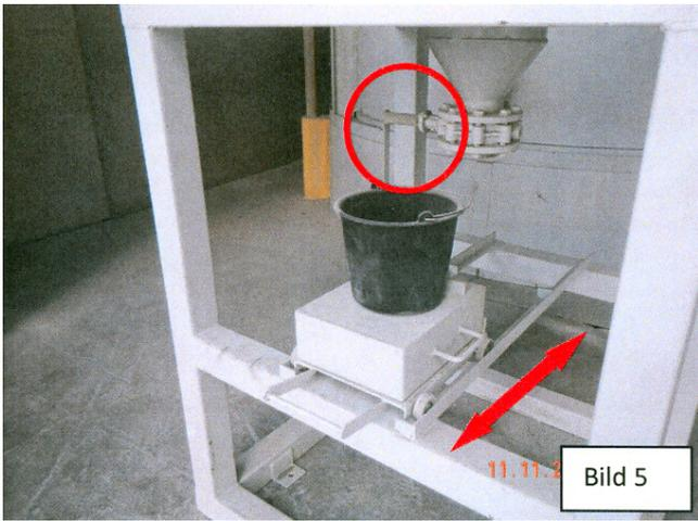
Das Gestell ist mit einem variablen Schlitten für verschiedene Probegefäße ausgestattet (Bild 5).
