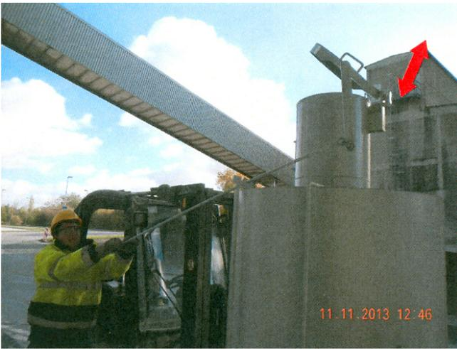
Der Deckel des Behälters kann vom Boden aus geöffnet, geschlossen und arretiert werden (Bild 3).
