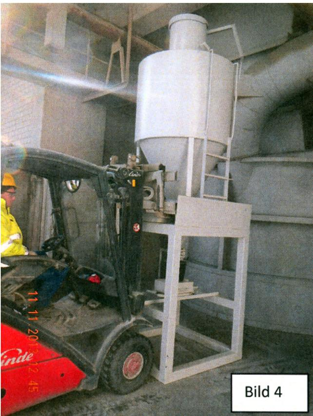
Der Behälter wird anschließend auf dem Gestell abgesetzt und der untere Auslass am Konus geöffnet (Bild 4).
