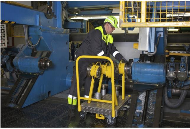
Albert Pörschke entwickelte einen Handwagen mit Aufbau, mit dem die Abwickelköpfe in ergonomischer Arbeitshaltung sicher abmontiert und gelagert werden können.
