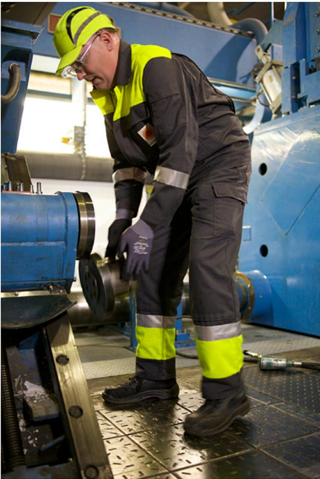
Die beiden Aufnahmen für die Hülsen einer Umrollmaschine müssen mehrmals täglich gewechselt werden.
