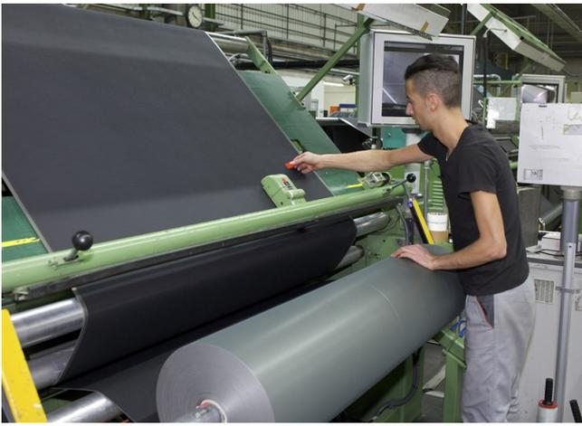
Im Verarbeitungsprozess muss die Folie mehrfach auf- und abgewickelt werden.
