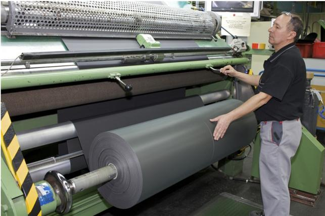
Beim neu entwickelten Eingreifschutz wird der Durchmesser des Wickels mithilfe zweier analoger Lichtschranken permanent gemessen und verglichen.
