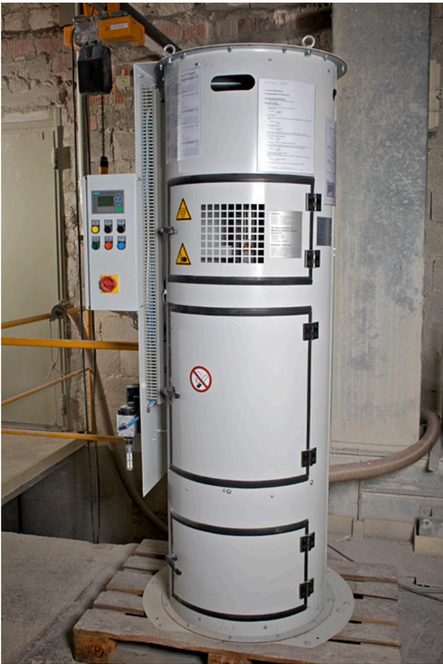
Gemeinsam mit der Firma Munder Engineering GmbH & Co KG entwickelte das Gewinnerteam die neue automatische Ausblasanlage zur Reinigung der Filterpatronen.
