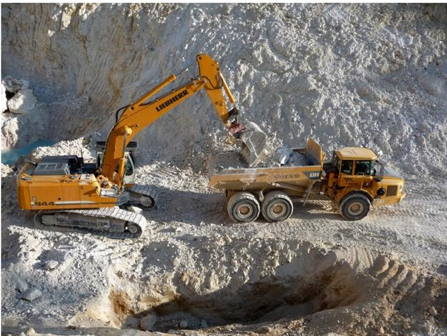
Kieselerdeabbau bei der HOFFMANN MINERAL GmbH. Die Staubfilter der großen Erdbaumaschinen müssen mehrmals wöchentlich gereinigt werden.
