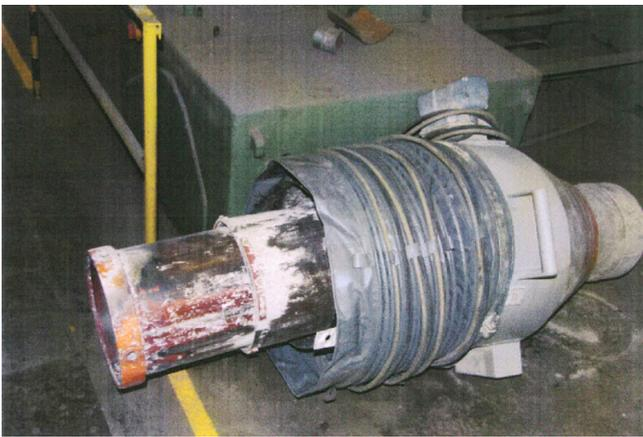
Ausgebauter Rüssel mit seinen Rohrelementen
