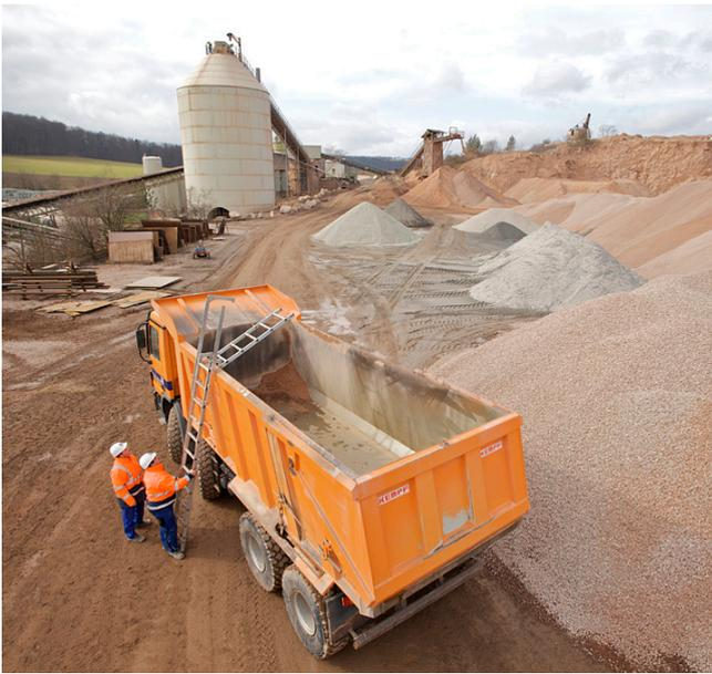
In allen Fahrzeugen, in denen Schüttgüter transportiert werden, muss ab und zu die Ladefläche gereinigt werden. Dazu ist die Einstiegshilfe das richtige Instrument.
