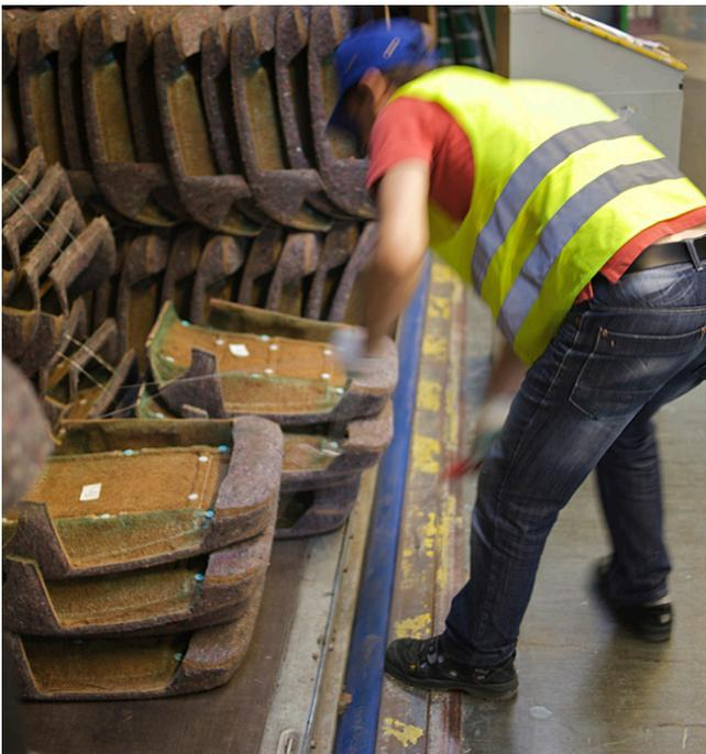
Dieser Spalt wird durch den aufblasbaren (hier blauen) Kunststoffschlauch verschlossen.
