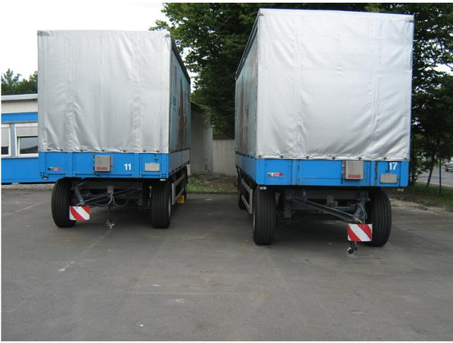
Die Lösung: Die Deichsel des Anhängers wird mit einem reflektierenden Warnschild gesichert.
