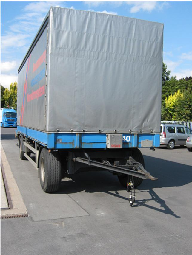
Bei einem auf dem Werksgelände oder auf einem Parkplatz abgestellten Lkw-Anhänger kann die Deichsel, bei Unaufmerksamkeit oder schlechter Sicht, leicht übersehen werden.
