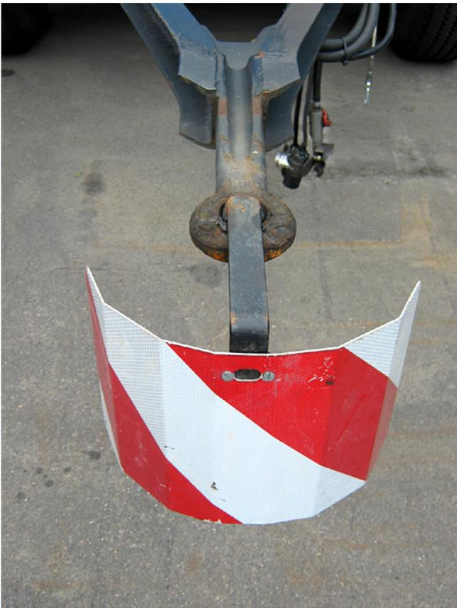
Simple und einfache Handhabung: Das Warnschild wird einfach in das Auge der Deichsel eingehängt.
