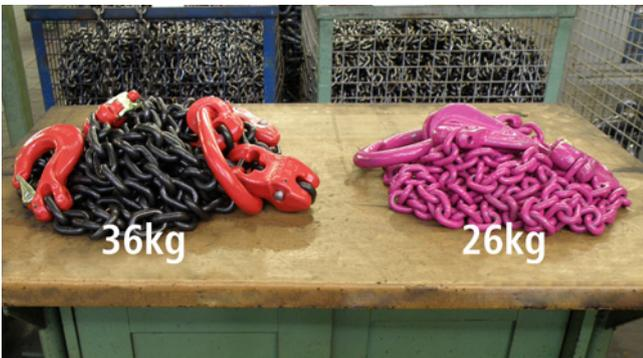
Der Vorteil des neuen Kettensystems: Gleiche Tragfähigkeit bei reduziertem Kettendurchmesser und -gewicht.
