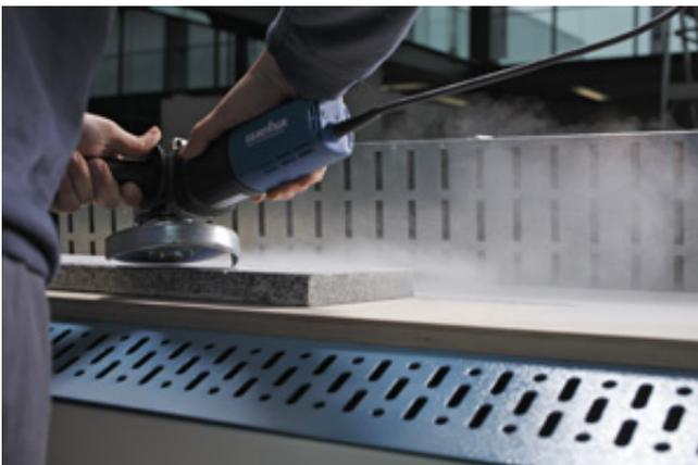
Die Absaugung des Polier- und Schleifstaubes erfolgt über eine versenkbare rückwärtige Absaugwand und variabel zuschaltbare Randsaugerheiten, eine staubfreie Entsorgung des Filterstaubes ist gewährleistet.
