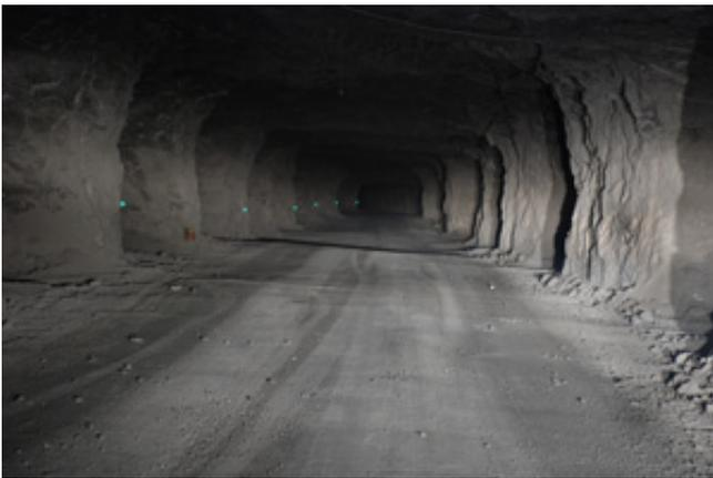
Gordon Büttner von der Grube Obrigheim der HeidelbergCement AG entwickelte eine effiziente Fluchwegeleitsystem für unter Tage. Dafür stattete er die Strecken mit roten und grünen Reflektoren „Katzenaugen“ aus, die bei Anleuchtung auch in verrauchten Strecken das Licht weithin sichtbar reflektieren. Diese Idee prämiert die Bergbau-Berufsgenossenschaft mit dem Förderpreis 2009 in der Kategorie „Organisation/Motivation“ in Höhe von 10.000 Euro.
