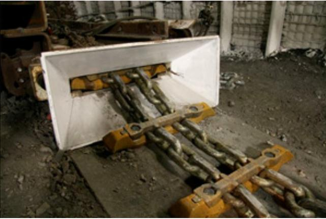
... Einlaufrichter der neuen Ketteneinzugsvorrichtung
